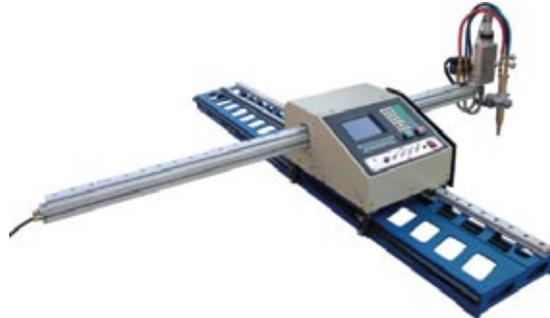
Мобильными консольными машинами термической резки с ЧПУ могут быть вырезаны листовые детали любой формы и конфигурации с использованием газо-кислородной или плазменной резки. Компактная конструкция делает такие машины лёгкими в перемещении и простыми в установке и запуске в производство. Эти машины могут использоваться как в цехах, так и на открытом воздухе – в условиях строительной или монтажной площадки.
