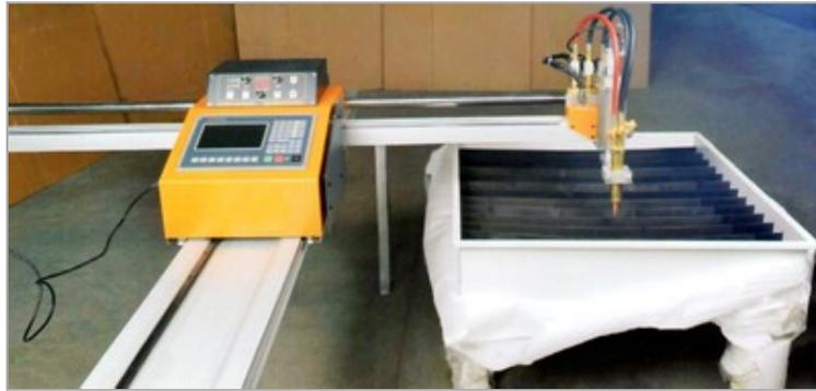
Переносная машина с ЧПУ для плазменной резки листовых деталей сложной формы. Мобильная, консольного типа, с лёгким и гибким управлением, с возможностью удлинения рельса. Датчик контроля высоты плазменного резака.
