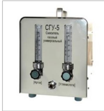
Механический смеситель газовый универсальный (AR/CO<sub>2</sub>) предназначен для получения двухкомпонентных газовых смесей стабильного состава. Используется совместно с баллонными редукторами-расходомерами. Смеситель СГУ-5 предназначен для использования в процессе полуавтоматической сварки в среде защитных газов, при этом максимальный расход на выходе – 25 л/мин.
